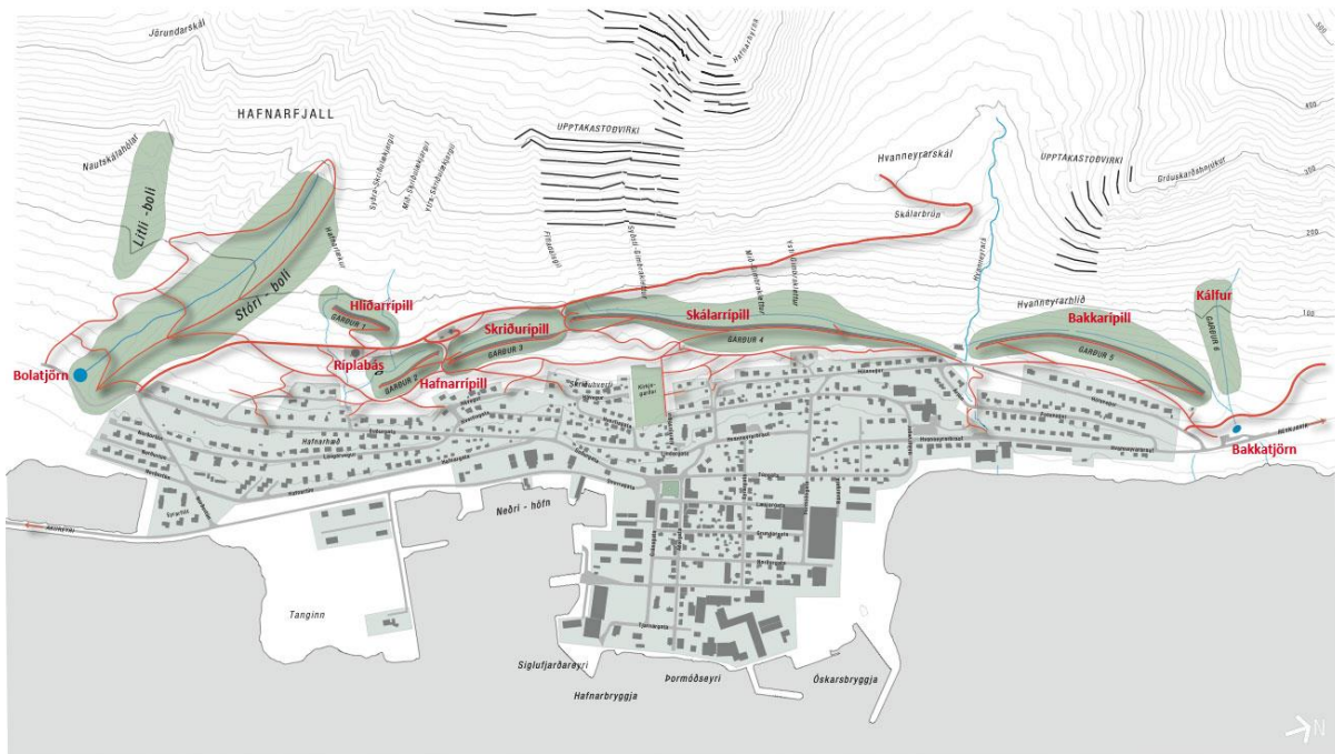
Mynd 18. Snjóflóðavarnargarðar ofan Siglufjarðar.
